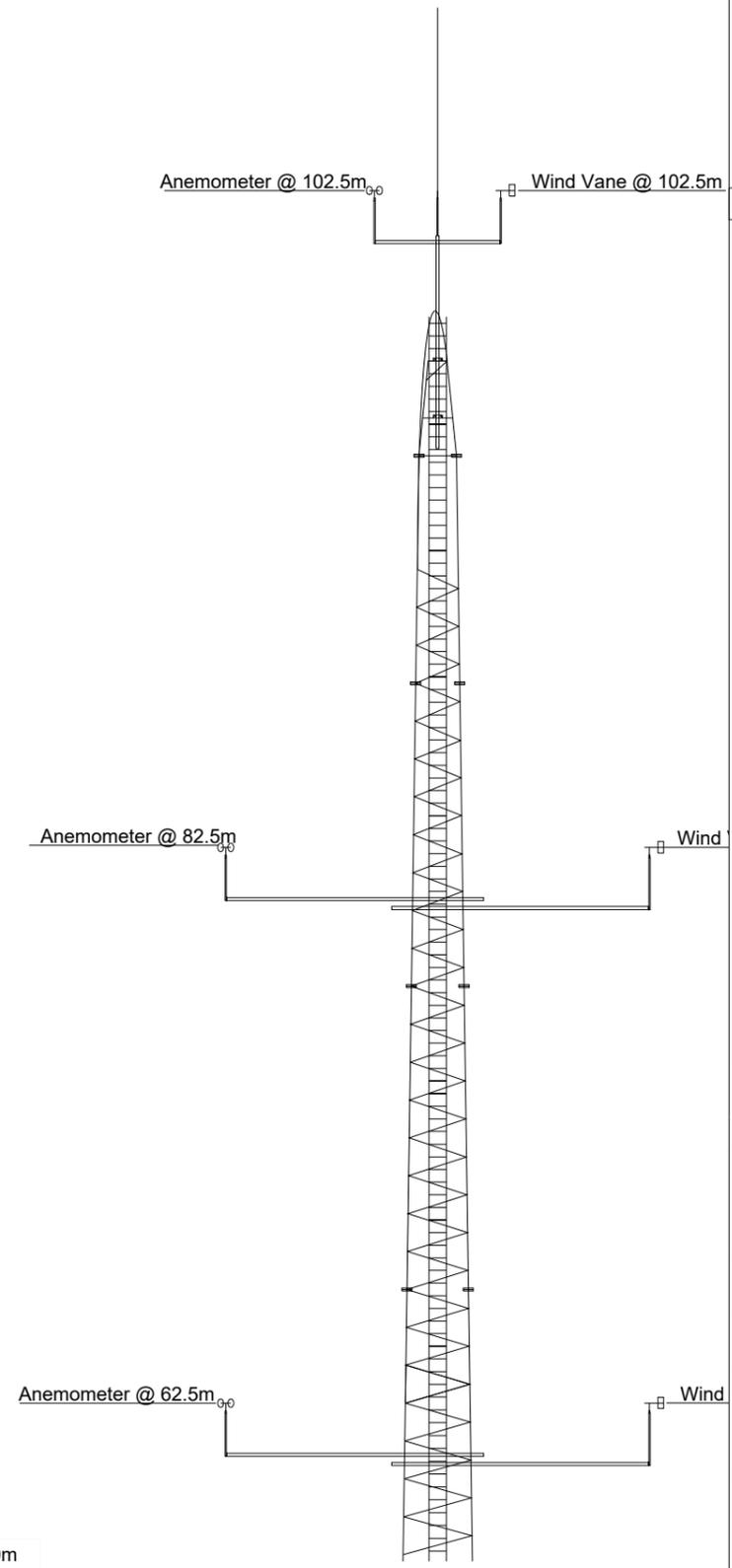
**ANEMOMETER & WIND VANE LOCATIONS**
